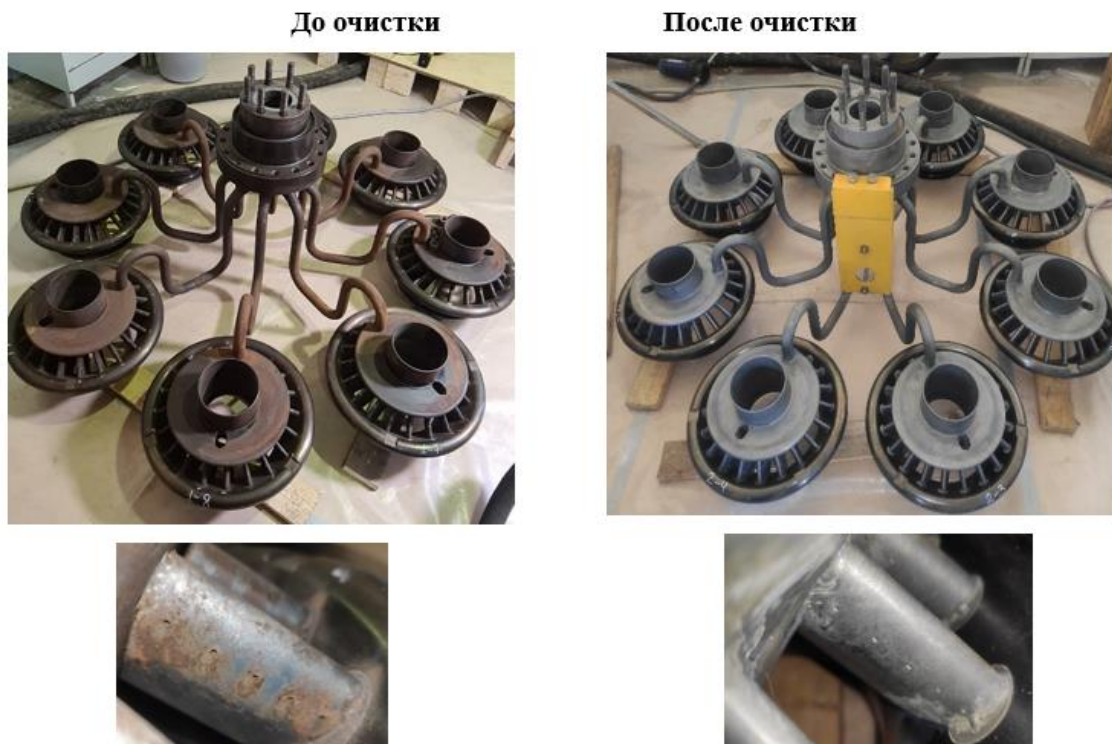
Рисунок 14. Фото газораспределителей ГТЭ-160 до и после ультразвуковой очистки (разработано автором)
