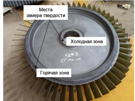
Измерение твердости (HV)
