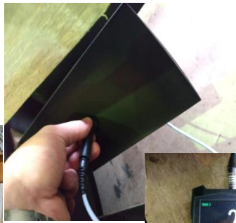
Измерение толщины защитного покрытия
