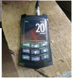
Измерение толщины защитного покрытия
