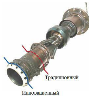
Рисунок 4 – Способы восстановления горелок зарубежными сервисными компаниями производителя
