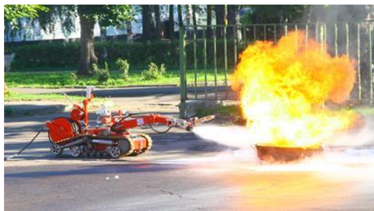
Рисунок 2 – Тушение очага пожара роботом МРК-РП с помощью пены низкой кратности
